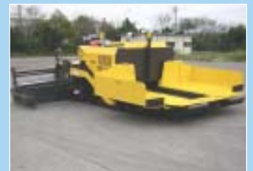
アスファルトフィニッシャー
